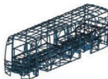
Com a estrutura de anel fechado de aço de alta resistência, a deformação máxima do pilar durante o capotamento é de apenas 260 mm.
